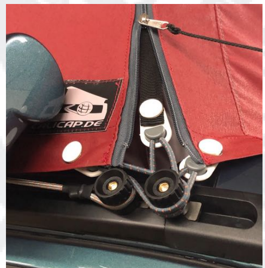
Beim Kederstein hinter der Markise ist der dünne Distanzring (Scheibe) zu verwenden
